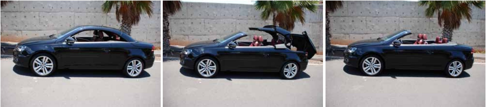
La capota, que queda recogida en el maletero, necesita tan solo veinticinco segundos para desplegarse (o plegarse) eléctricamente. Cerrado: un moderno coupé. Abierto: un divertido descapotable.
