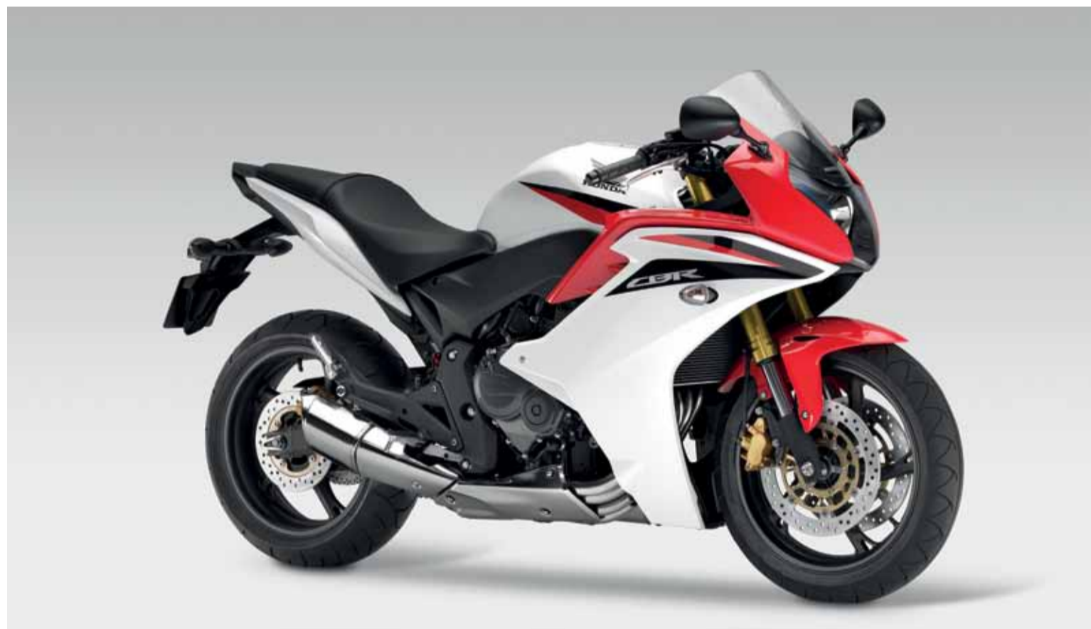
La configuración de diamante del Mono-Backbone, ligera pero rígida, incorpora al motor como parte integral del bastidor.
