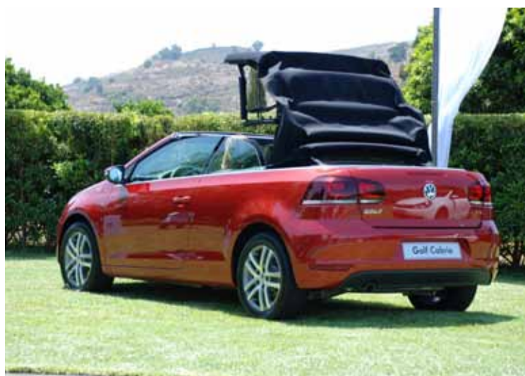
Apertura electrohidráulica, tan sólo 9 segundos, incluso a velocidades de 30 km/h.
